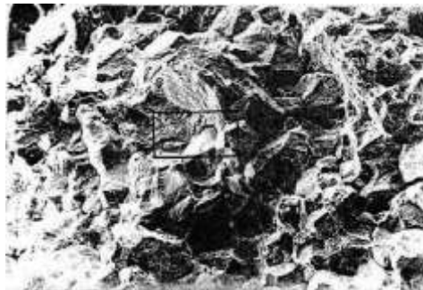
Рисунок 1.5 – Мікрофрактографічні особливості міжзеренного корозійного механізму руйнування, х 400
